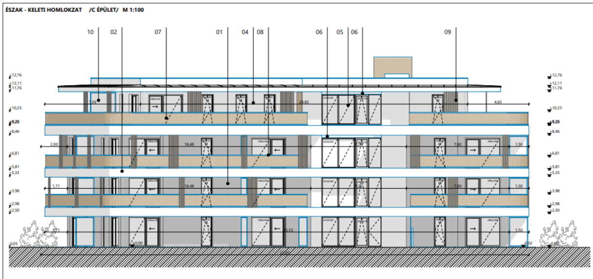
8.5.7. kép: A C épület észak-északkeleti homlokzata. Forrás: építési engedélyezési dokumentáció, Bplan Architect Kft.
